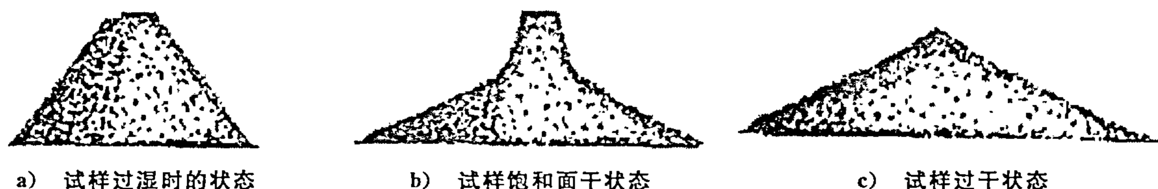
图3 机制砂饱和面干试样的状态
